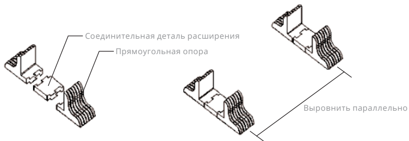
Рис. 3.2.4.2. Схема сборки опор
